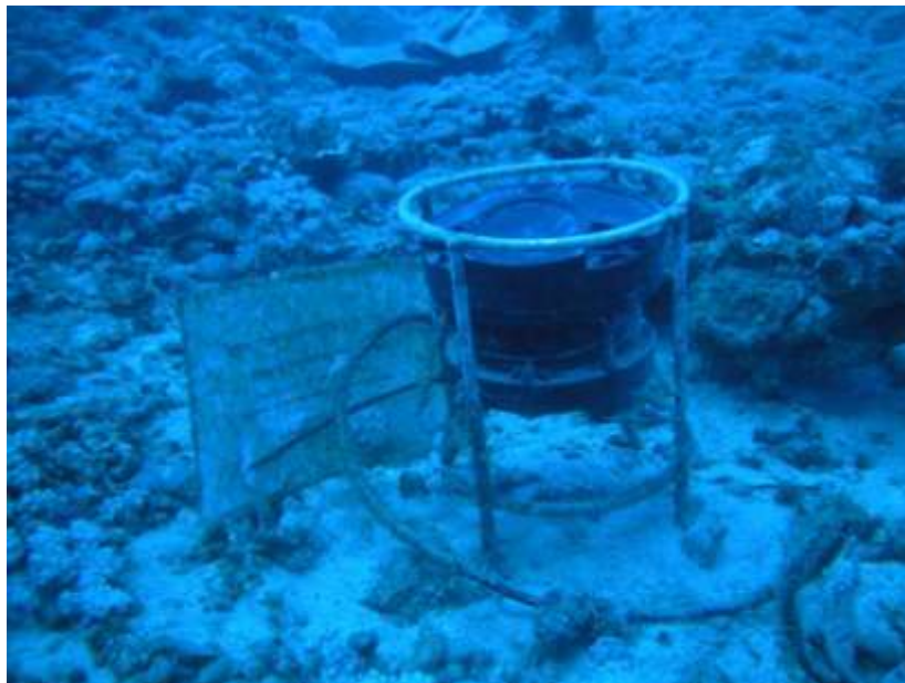
איור ה-11: מכשיר ה-ADCP על קרקעית הים בעומק 24 מ', מול הקצה הדרומי של המכון הבין-אוניברסיטאי. המכשיר מחובר בכבל תקשורת וחשמל ומזין נתונים ישירות לשרת המכון.
