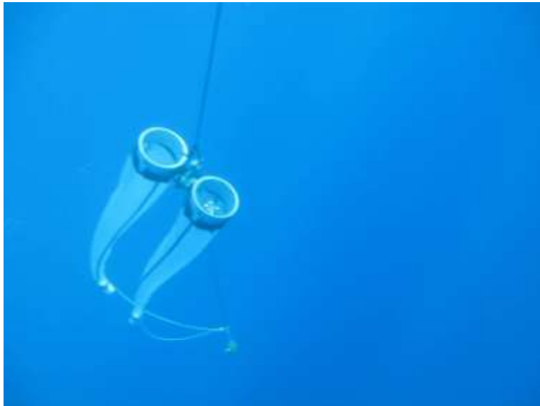
איור ד38: רשת הפלנקטון הכפולה ("Bongo") נגררת מהסירה בים העמוק. צילום: מ. צ'רניחובסקי Figure D38: A double plankton net ("Bongo") towed from the boat in deep waters. Photo: M. Chernihovsky
